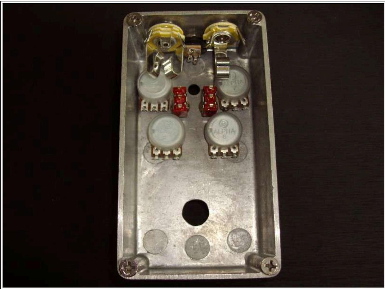
Comme vous le voyez c'est relativement serré, et même si les connexions des potentiomètres et des switch sont isolées à la gaine thermo-rétractable, il vaudra toujours mieux serrer correctement ces derniers tout en les maintenant pour ne pas qu'ils "tournent" et restent bien en position comme sur la photo.
